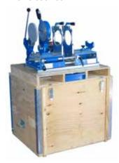
PSO 701 Stumpfschweißmaschine für Sanitärinstallationen und Abflußleitungen.
